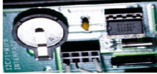
Sensor de temperatura DS18B20 integrado dentro del PIC'School
