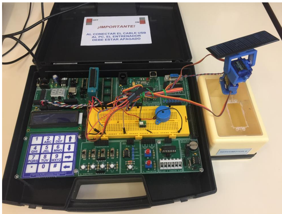
Figura 1. Fotografía del proyecto: "Automatización de una placa solar" finalizado.
